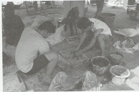
ภาพที่ 1 การผสมดินดาก แกลบเบ้ง (แกลบขาว) และขี้เถ้าแกลบ (แกลบดำ)
