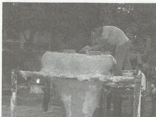
ภาพที่ 12 ช่างทำการปิดรอยแตกร้าวต่างๆ ก่อนการเททอง
