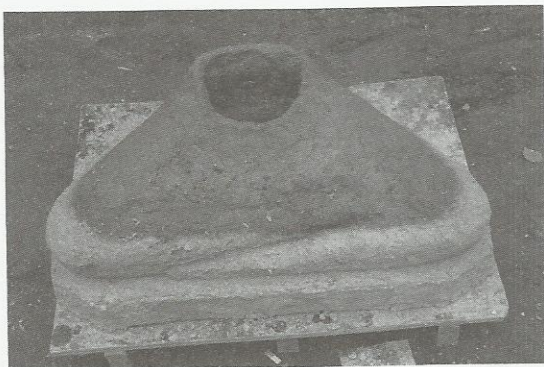
ภาพที่ 2 การปั้นขึ้นไปทีละชั้นแล้วนำไปตากแดดให้แห้ง
